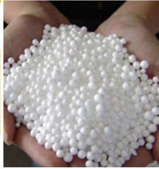
disolver el poliestireno en un solvente soluble en agua; una vez homogeneizada esta mezcla, la dispersión de esta disolución polimérica en líquido genera partículas de poliestireno con una porosidad característica.
